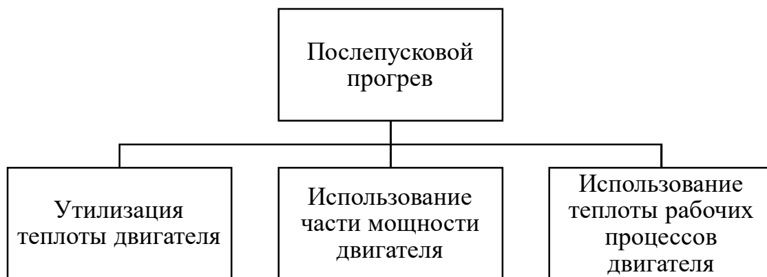
Рисунок 1.7 - Способы и средства послепусковой тепловой подготовки
