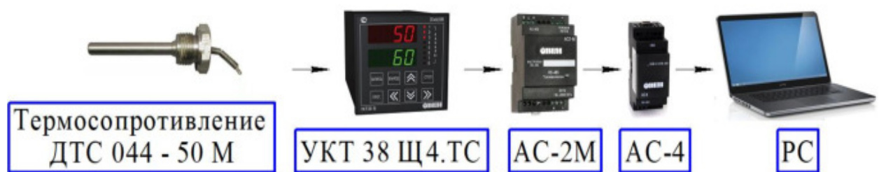
Рисунок 3.15 – Схема подключения измерительного оборудования
